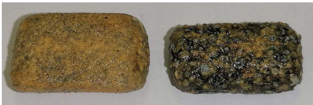
Рис. 1. Внешний вид образцов графита с покрытиями. Слева состав 1, 1200 °C 4 ч, справа состав 2, 1300°C 4 ч (неизотермический режим).
